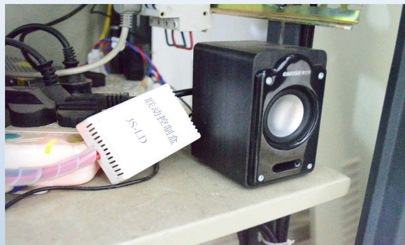
DZJK数据采集器通过联动控制盒重启地震数据采集器
